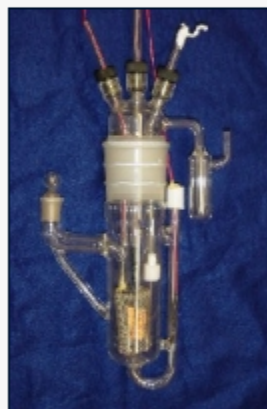
Sådan en lille opstilling er nok til at påvise eksistensen af neutroner i et forsøg, der søger at påvise, at den kolde fusion lader sig gennemføre. (Foto: Wikipedia)
